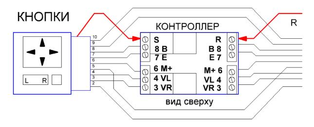
**Внимание!** Нумерация контактов разъема блока кнопок идет с цифры 2, так устроен разъем, к первому контакту не подключен провод, поэтому проводов всего девять!
