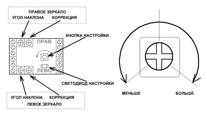
Для начала необходимо выставить необходимый угол отклонения зеркала. Включая и отключая заднюю передачу, и изменяя положение потенциометра можно увеличивать и уменьшать угол отклонения. Сначала одну сторону, затем другую.
